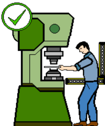
Protezione orizzontale e verticale
